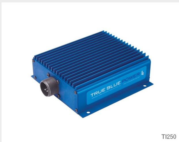
El convertidor CC a CA de la serie TI250 altamente eficiente produce 250 vatios de potencia a partir de la entrada de 28 VCC de una aeronave. Fabricado para funcionar con mayor refrigeración y con un diseño sin ventilador, la serie TI250 ahorra energía y reduce el peso. Estos inversores son más ligeros y pequeños que las unidades de la competencia e incluyen protección contra sobrecargas, cortocircuitos e interruptores de falla a tierra.
